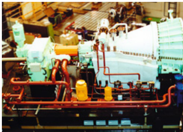
Bando di Argenta, Италия, конденсационный турбоагрегат мощностью 13 МВт для электростанции на древесном топливе.
